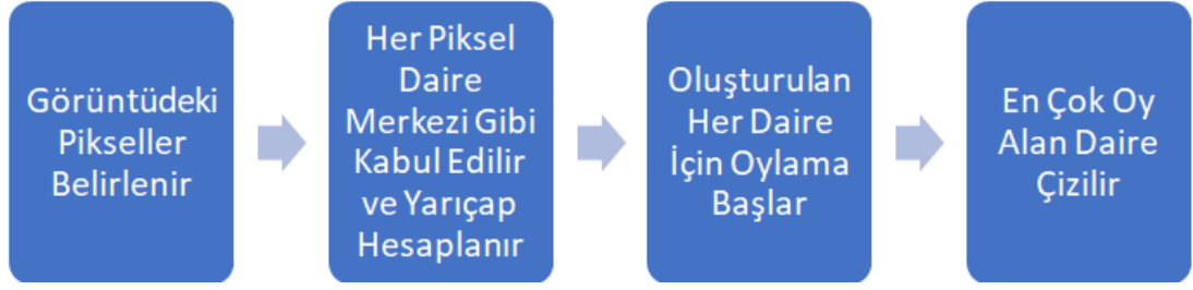
Şekil 3.4. Hough Daire Dönüşümü Oylaması Akış Şeması
