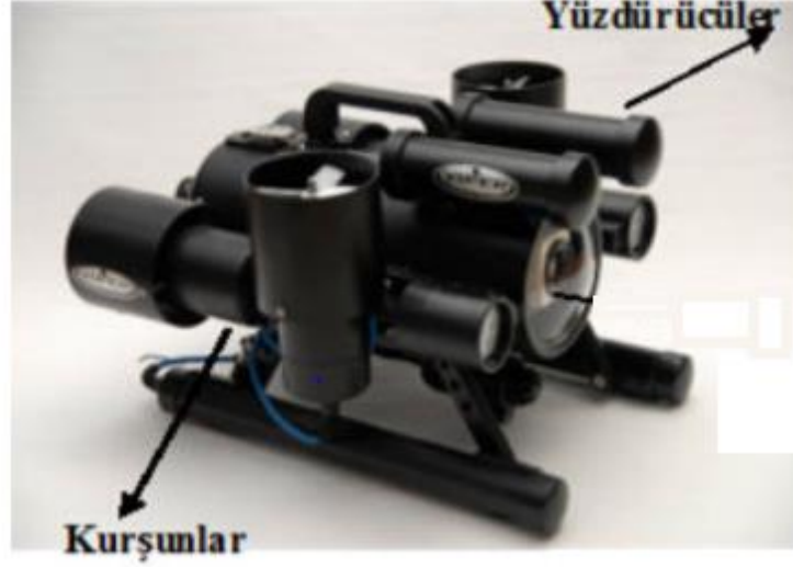
Şekil 2.2. Aracın Denge Ekipmanlarının Gösterimi [3]
