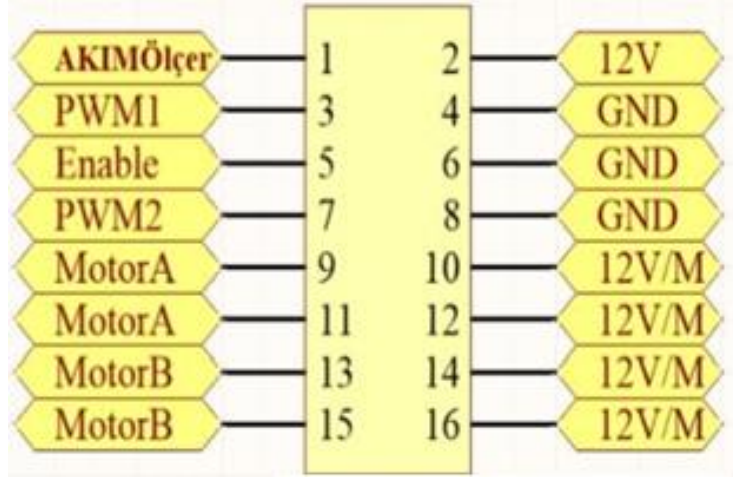
Şekil 2.5. Motor Sürücüsünün Pinleri Gösterimi [8]
