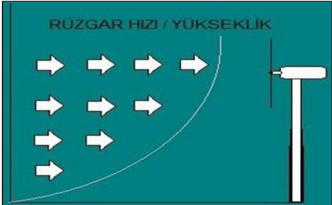
Şekil 1.12. Rüzgâr hızı ile yükseklik arasındaki ilişki [31].
