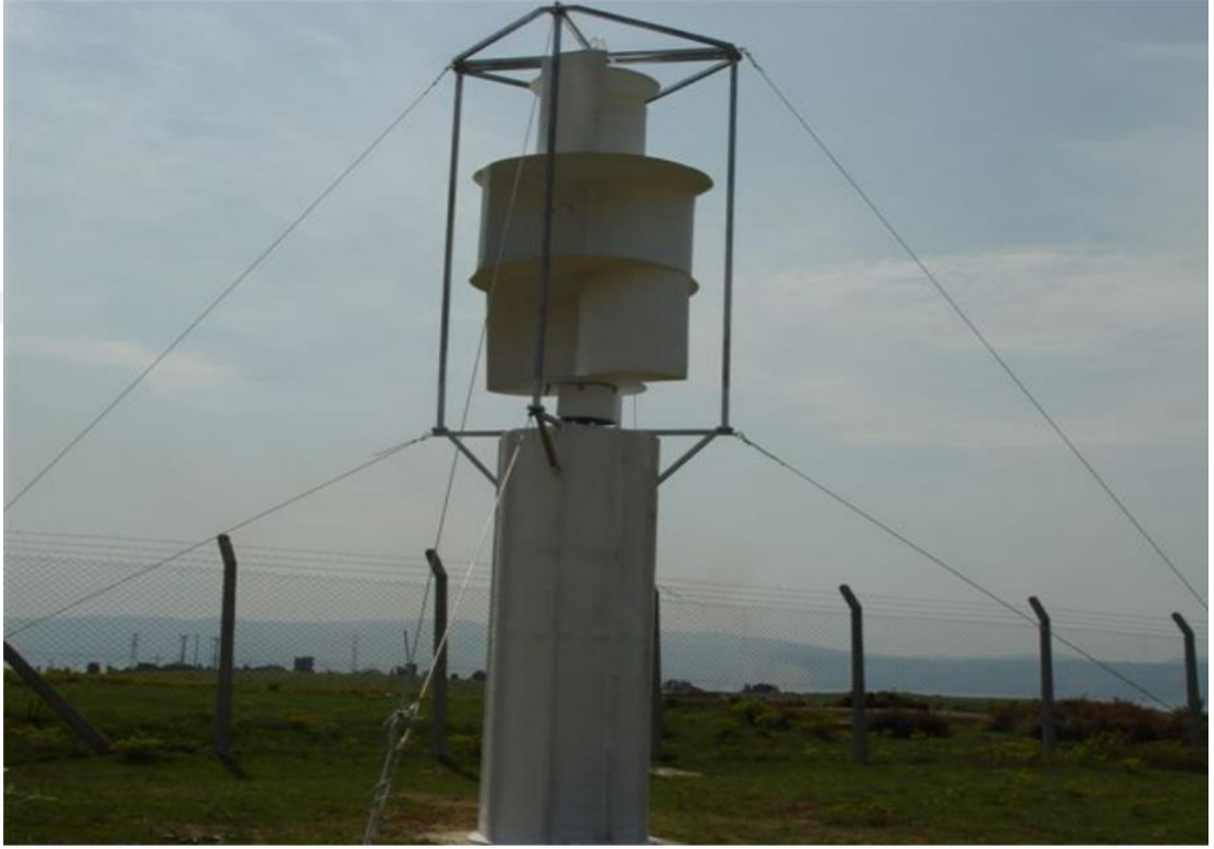
Şekil 1.24. Savonius tip dikey eksenli rüzgâr türbini [46].
