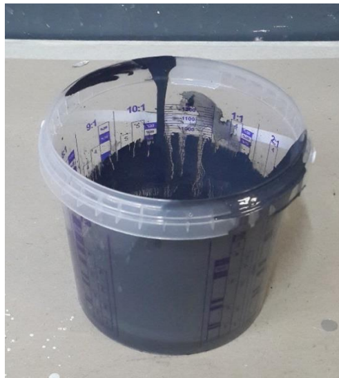
Şekil 4.3. Anti-statik boya, aktivatör ve incelticinin 3:1:1 oranına uygun olarak elde edilen karışımı
