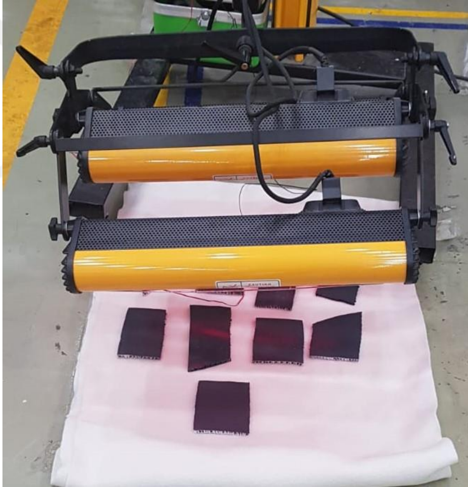
Şekil 4.6. Numunelerin fırınlama sonrası ışına tutularak kurutma işlemi
