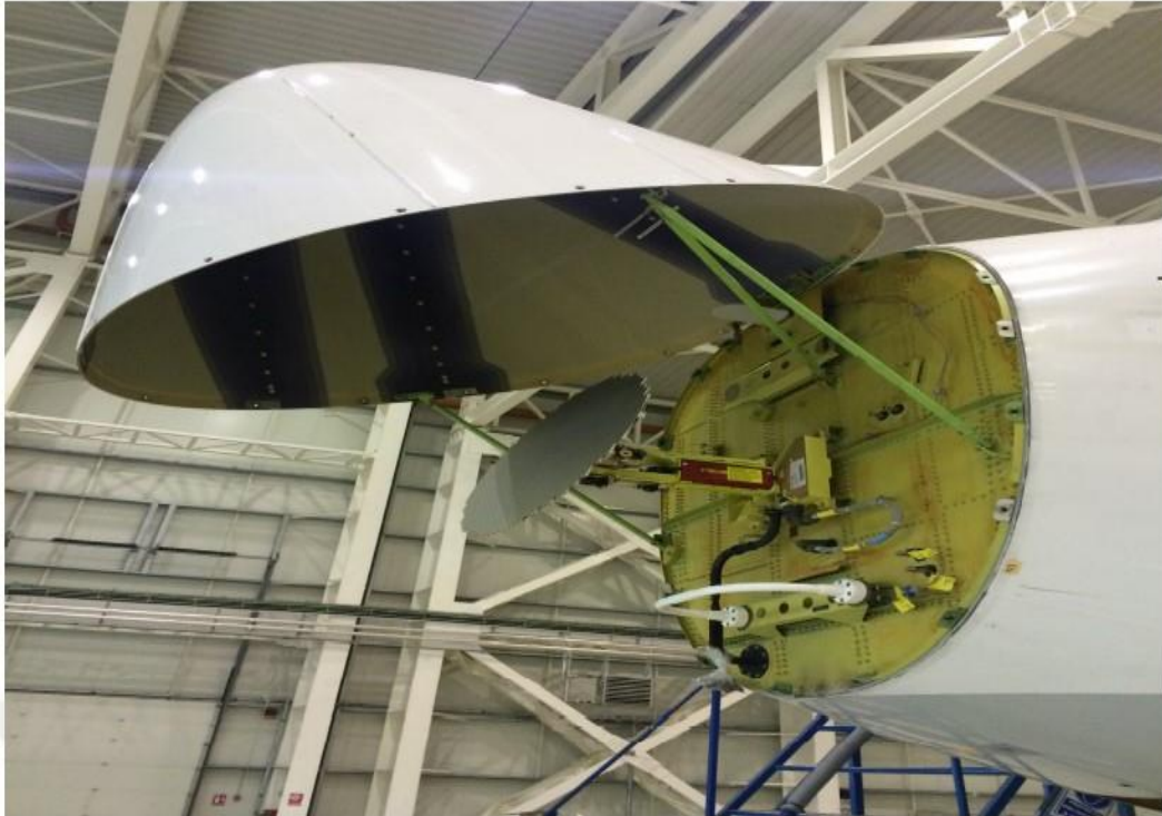
Şekil 3. 9. Boeing 737-800 uçağında radome ve iç kısmındaki radar antenleri [24]
