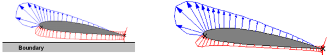
Şekil 2.4. Yer etkisinde iken ve değilken yüzeydeki basınç dağılımı [34]
