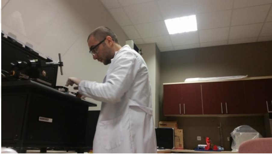
Şekil 2.21. Nanovea TRB aşınma makinesi (pin on disc)
