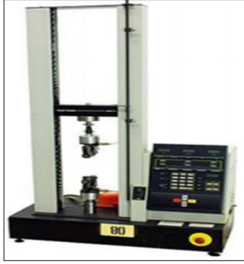
Şekil 2.19. Instron 4411 test makinesi -çekme çeneleriyle- görüntüsü
