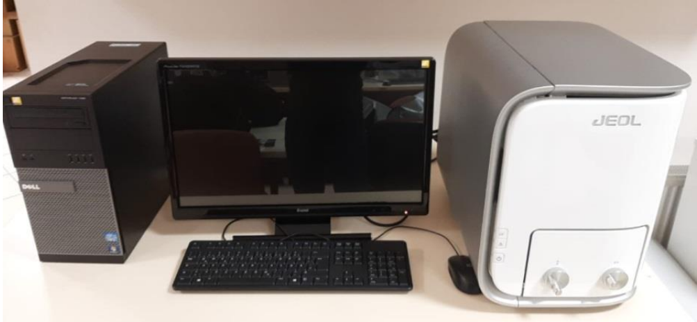
Şekil 2.23. Jeol JCM-600 BENCHTOP taramalı elektron mikroskobu (SEM)
