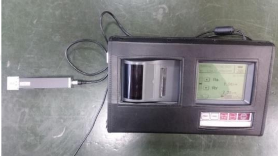
Şekil 2.18. Mitutoyo SJ-301 yüzey pürüzlülüğü ölçme cihazı
