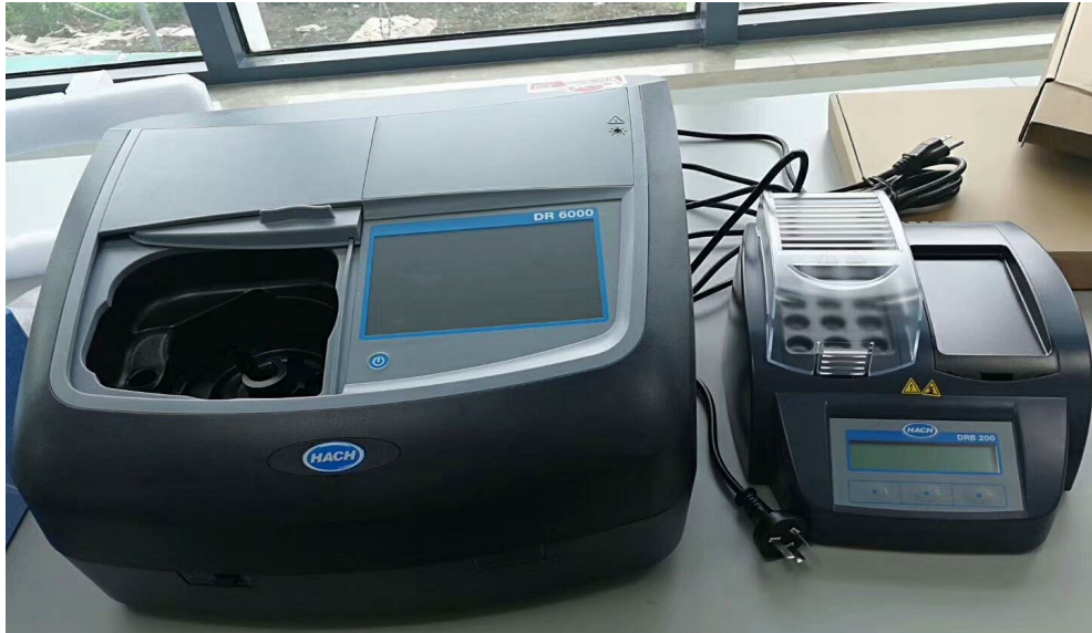
Şekil 2.2. EF sisteminde kullanılan UV-Visible spektrofotometre.
