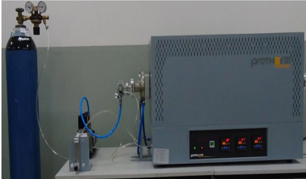
řekil 2.4. EF sisteminde kullanılan gaz beslemeli tp fırını.
