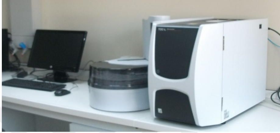
řekil 2.3. EF sisteminde kullanılan TOK cihazı.
