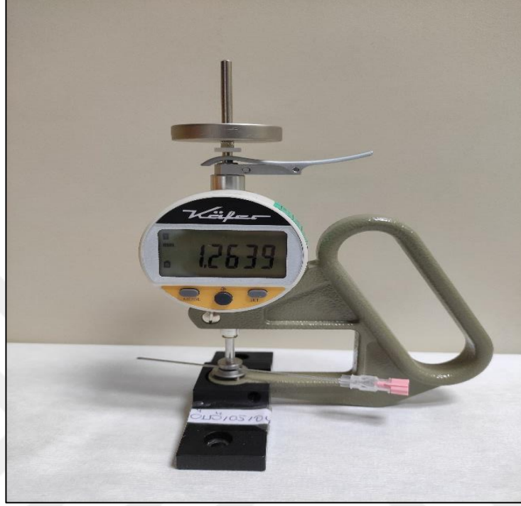
Şekil 2.5. 18 G iğne dış çap ölçümü
