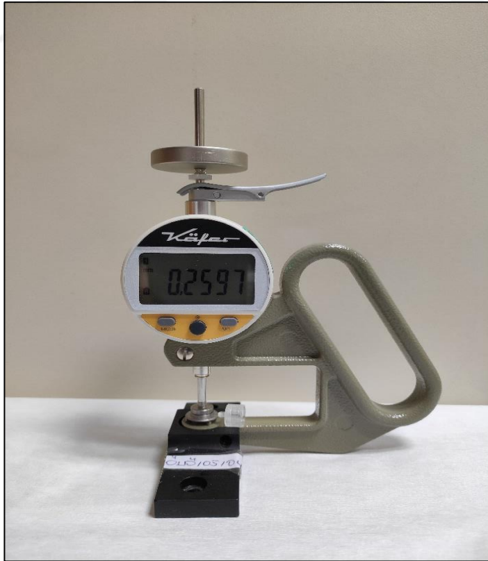
Şekil 2.10. 31 İğne dış çap ölçümü
