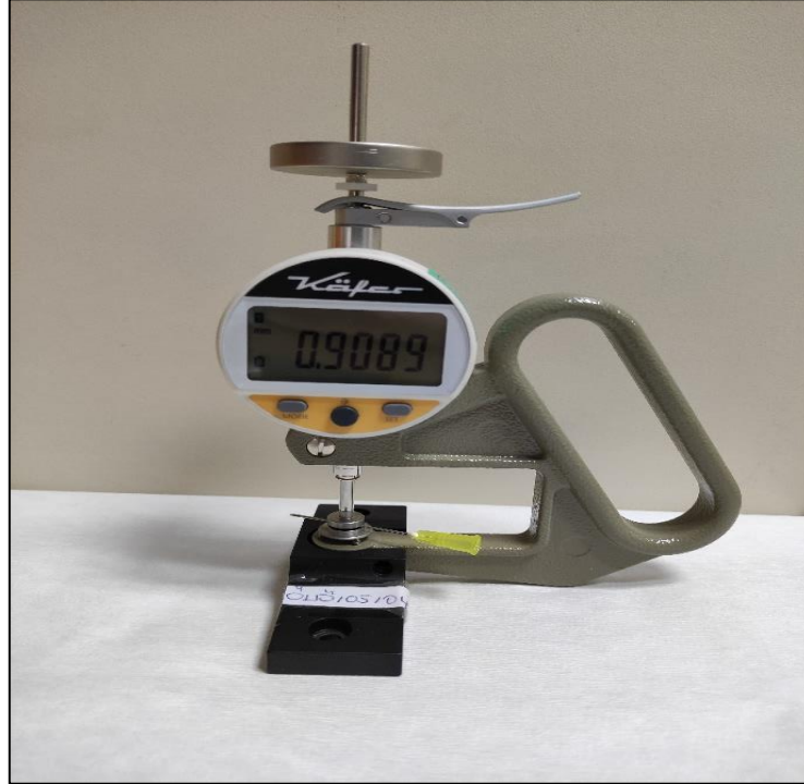
Şekil 2.6. 20 G iğne dış çap ölçümü
