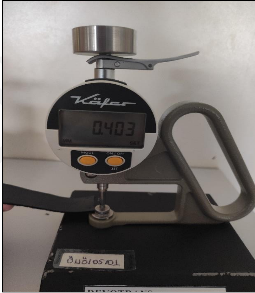
řekil 2.16. Suni deri malzeme çap ölçümü
