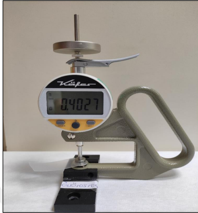
Şekil 2.4. PU Film yüzeyin çap ölçümü
