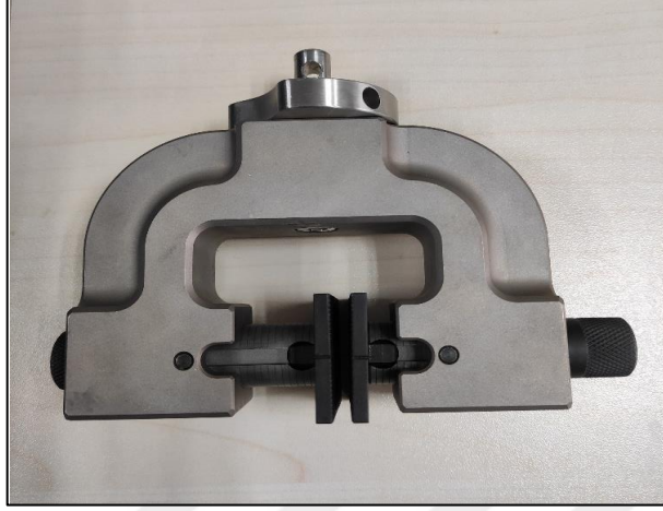
Şekil 2.2. İğnenin sabit tutulmasını sağlayan cihaz aparatı
