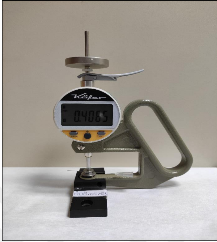
Şekil 2.9. 27 G iğne dış çap ölçümü
