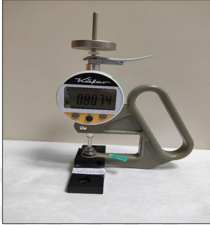
Şekil 2.7. 21 G iğne dış çap ölçümü
