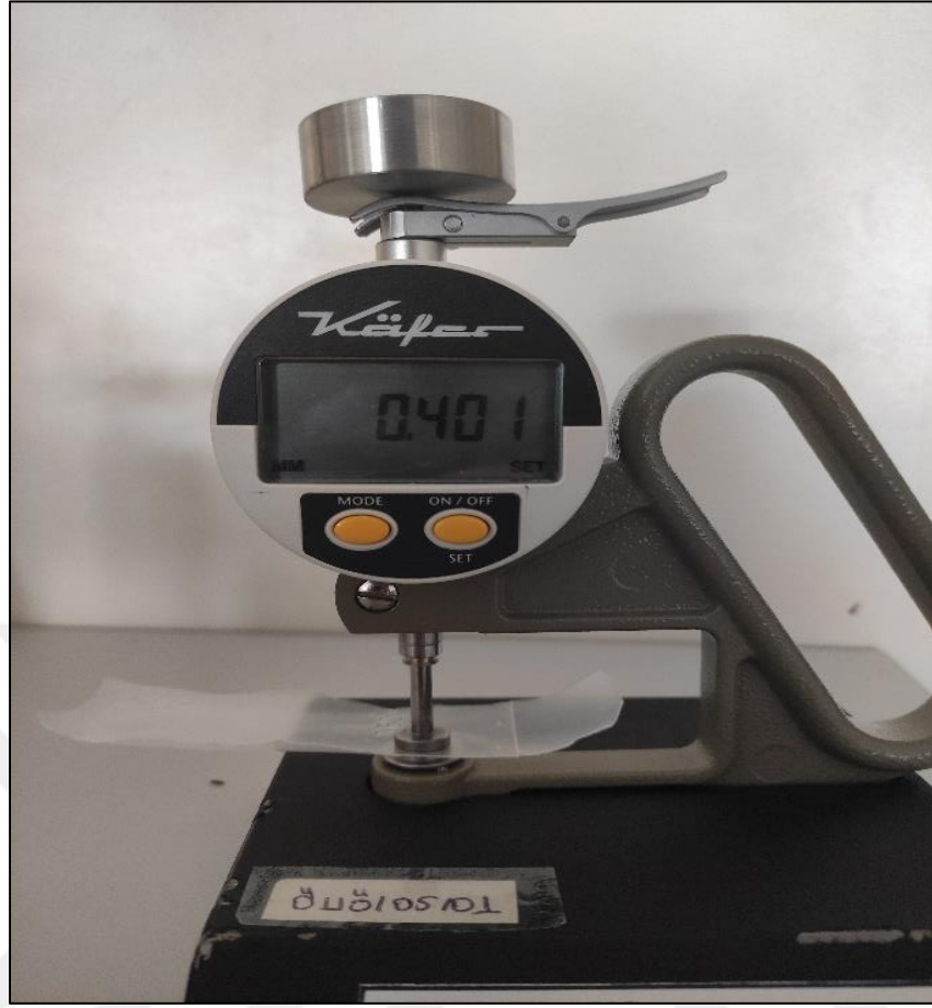
Şekil 2.17. PP malzeme çap ölçümü
