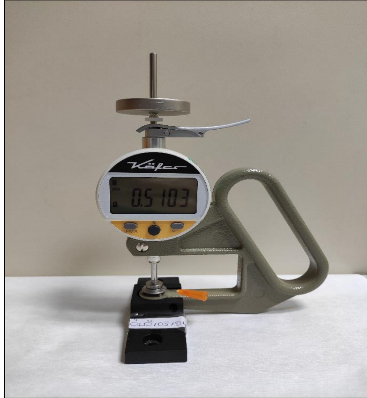
Şekil 2.8. 25 G iğne dış çap ölçümü
