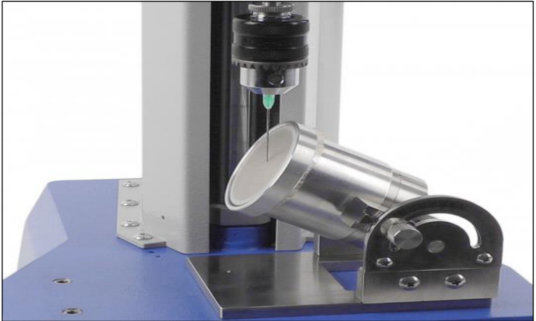
řekil 1.19. İęnenin penetrasyon kuvvet ölçümünün yapıldıęı örnek bir düzenek
