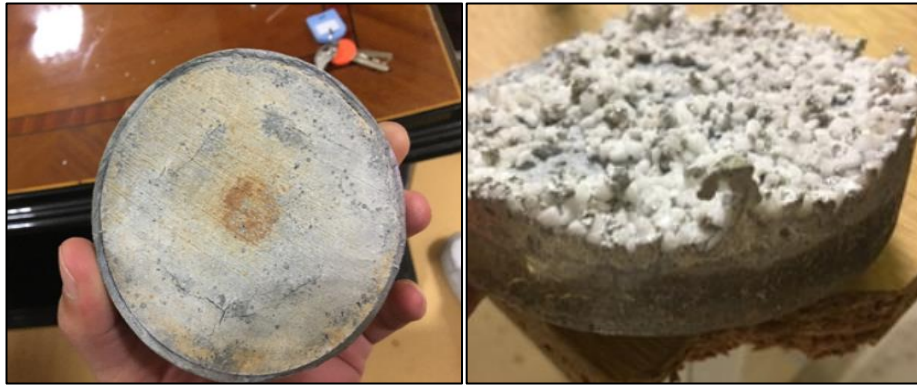
Şekil 5.1. Yeterli sızma kabiliyetine sahip olmayan alüminyum yapılar
