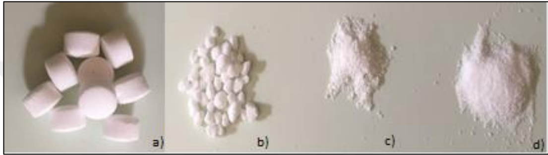
Şekil 4.10. Mekanik yöntem ile parçalanmış tuz parçacıkları a) Parçalanmamış b) 2-4 mm c) 1-2 mm d) 1-0,5 mm
