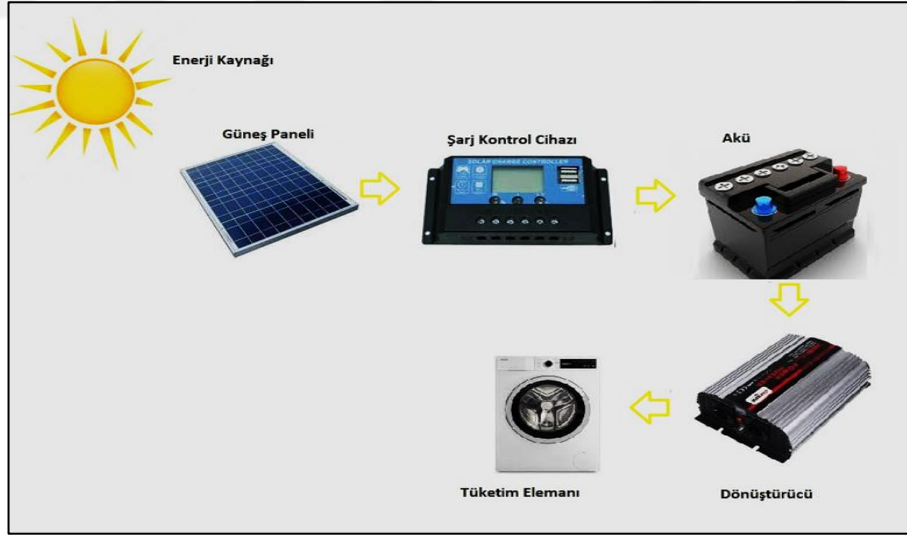
Şekil 2.2. Fotovoltaik şebekeden bağımsız sistemler
