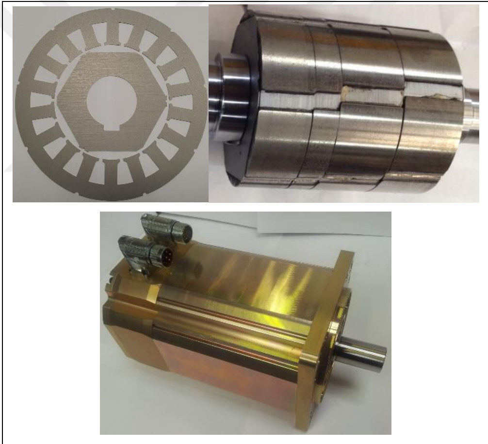
Şekil 6.10. DMBDKA, 4 segmentli yapıya ait prototip üretim görüntüleri (a) laminasyon yapısı, (b) mıknatısları yapıştırılmış rotor nüveleri ve (c) nihai prototip
