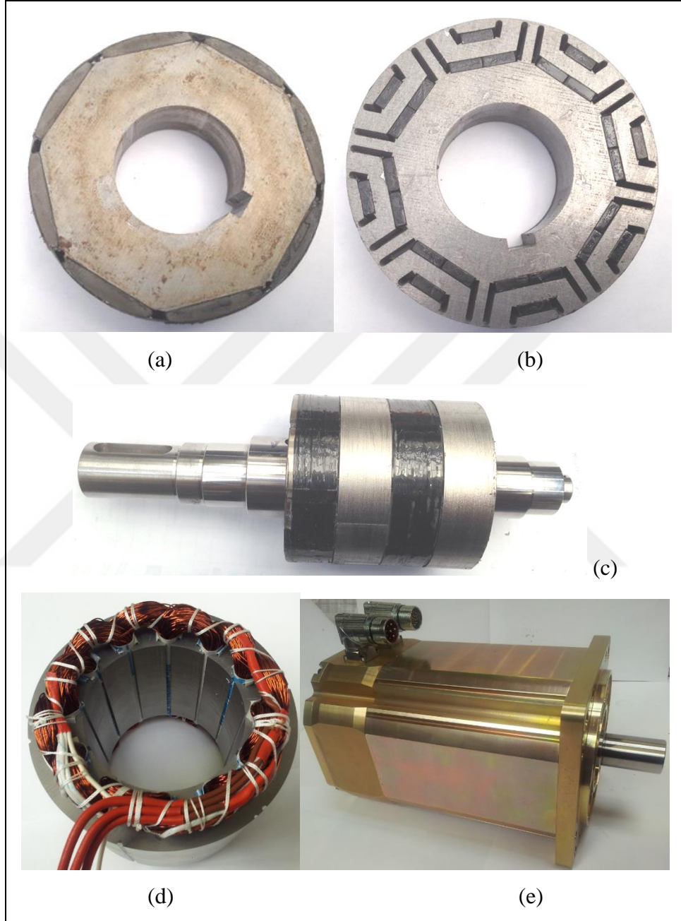
Şekil 5.9. SMHSM prototip üretim görüntüleri (a) YM segment, (b) DM segment, (c) SMHSM rotoru, (d) stator ve (e) SMHSM prototipi
