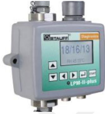
Şekil 3.5. Yağ kirlilik ölçüm cihazı ve parametreleri
