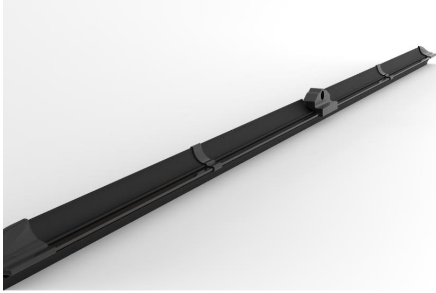
Şekil 3.5. Sileceğin CAD ortamında modellenmesi
