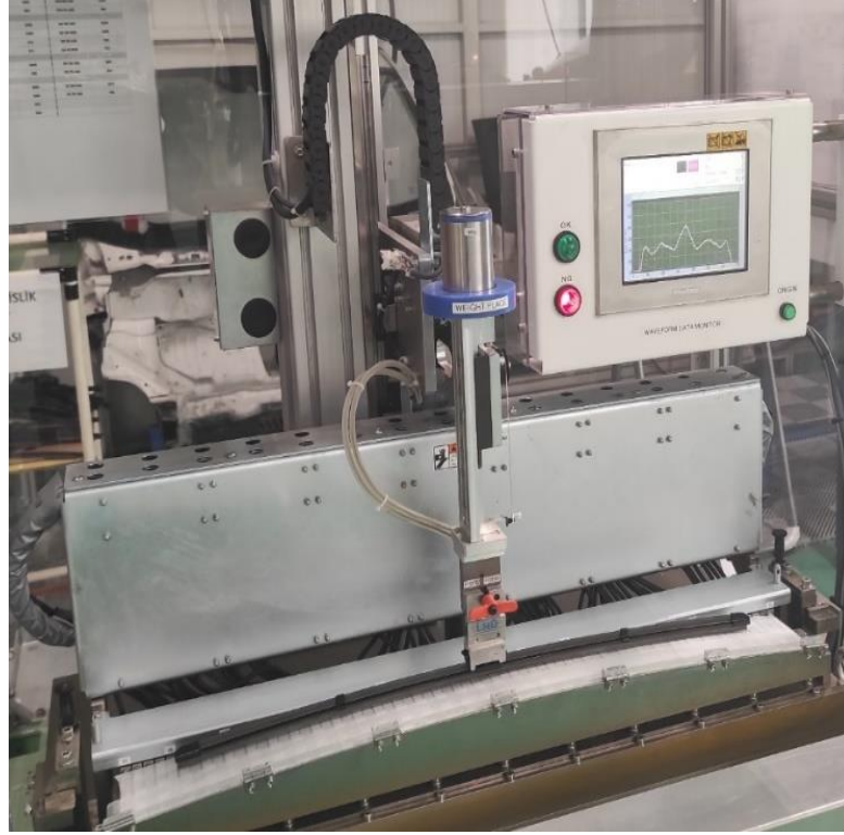
Şekil 4.7. Süpürgelerin yük dağılımlarının ölçümü
