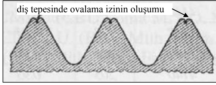
Şekil 1.42. Ovalamada diş tepesinde yığılmanın oluşumu [106]
