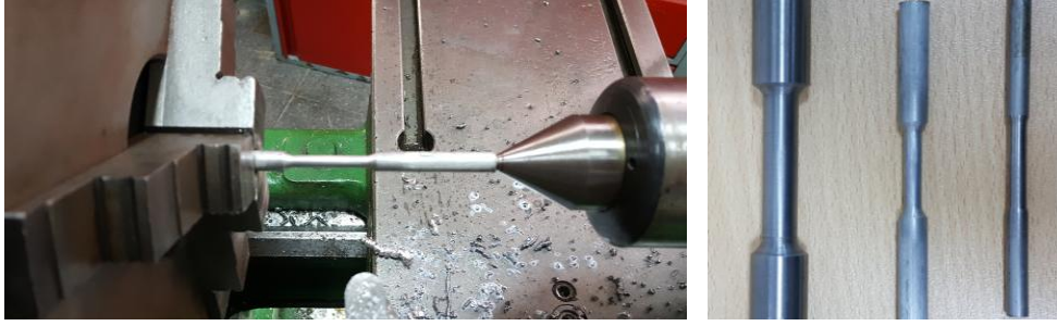
Şekil 2.2. Çekme testi için üretilen silindirik test çubukları
