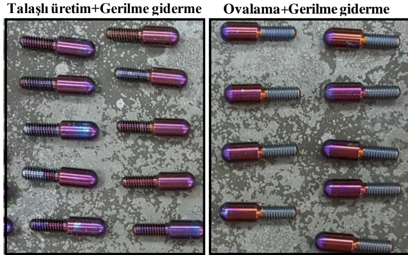
Şekil 4.8. Numunelerin gerilme giderme tavına tabi tutulması
