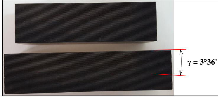
Şekil 3.11. Vida helis açısının kalıp üzerindeki gösterimi
