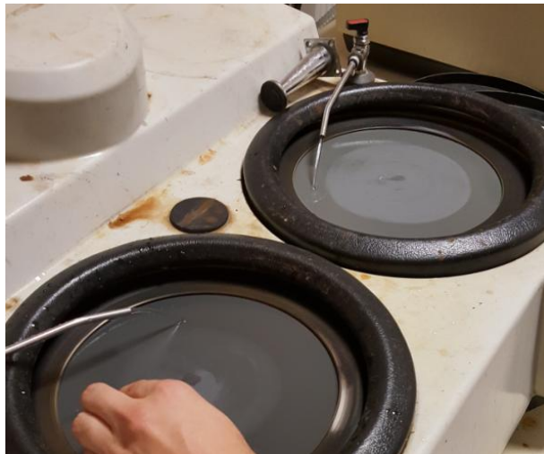
Şekil 6.4. Bakalite alınmış numunelerin zımparalama ve parlatma işlemi
