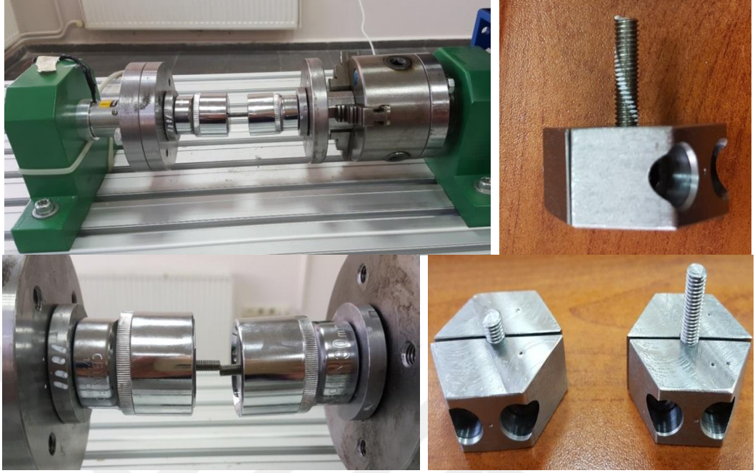
Şekil 2.13. Burulma testlerinin yapılması
