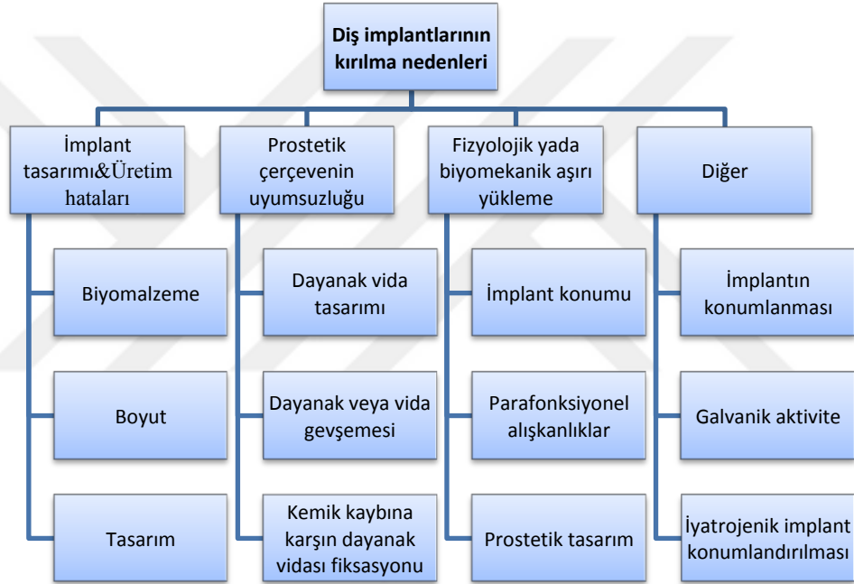
Şekil 1.15. İmplant kırıklarının nedenleri [3]
