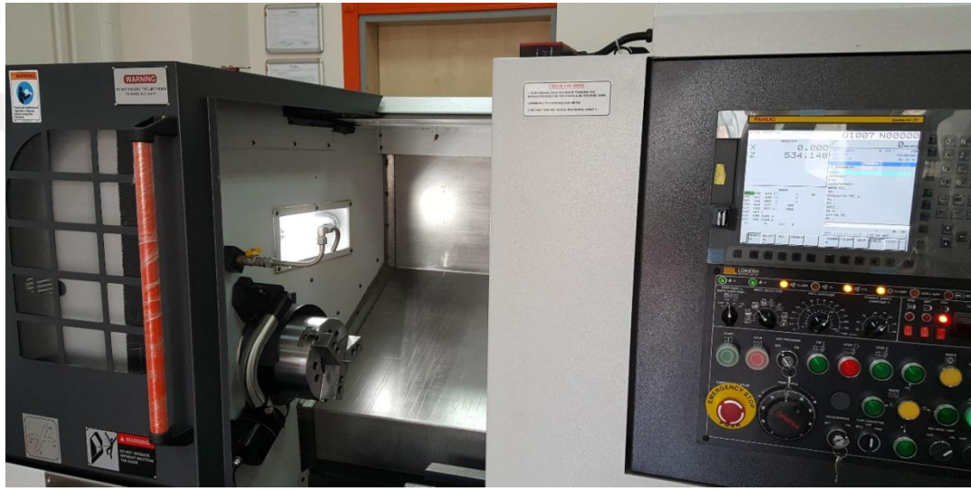
Şekil 4.2. Diş implant numuneleri üretiminde kullanılan CNC torna tezgahı
