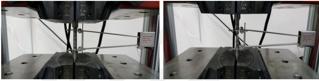
Şekil 2.2. Çekme testi için üretilen silindirik test çubukları
