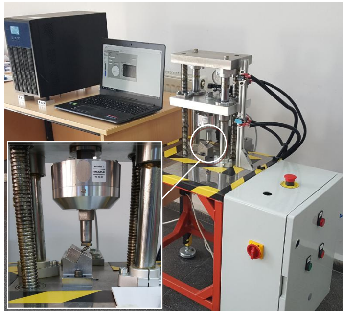
Şekil 6.1. Diş implant basma test sistemi
