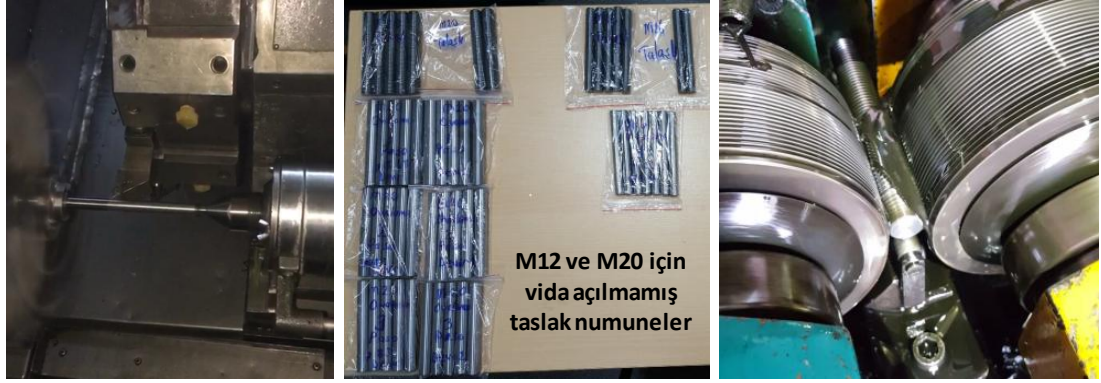
Şekil 2.28. Numunelerin üretim aşamaları a) diş açılmamış numunelerin işlenmesi b) diş açılmamış numuneler c) ovalama ile numunelere diş açılması [110]
