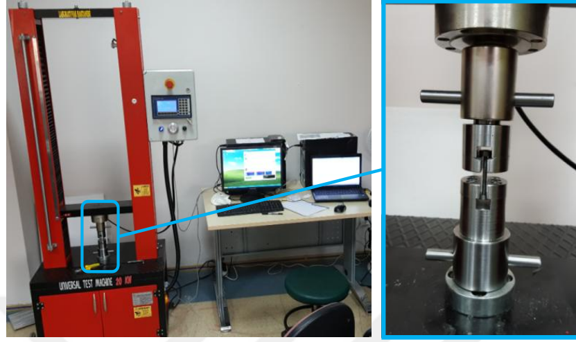
Şekil 2.12. Çekme test sistemi ve uygulaması
