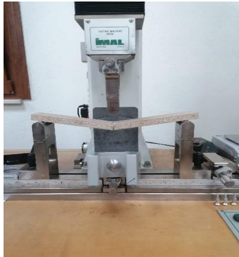
Şekil 3.8. Eğilme Direnci ölçümü yapılırken numunenin ve cihaz aparatının görüntüsü
