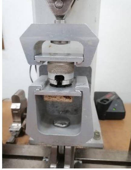
Şekil 3.10. Yüzey dayanıklılığı ölçümü gerçekleştiren cihaz aparatı
