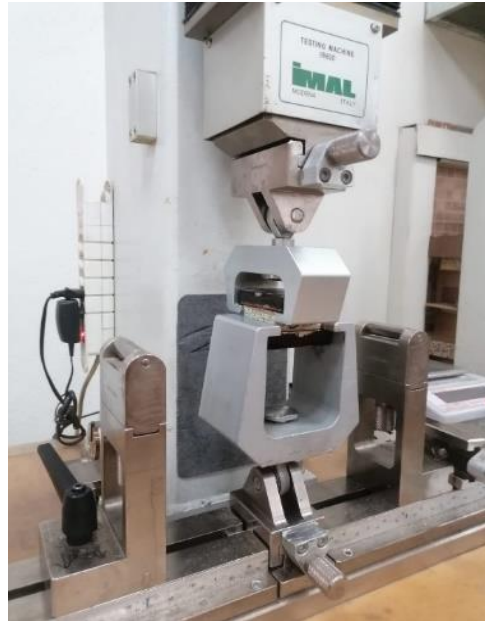
Şekil 3.9. Yüzeye dik yönde çekme testi yapılan cihaz görüntüsü
