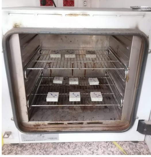
Şekil 3.7. Etüv yardımıyla kurutması sağlanan yonga levha numuneleri
