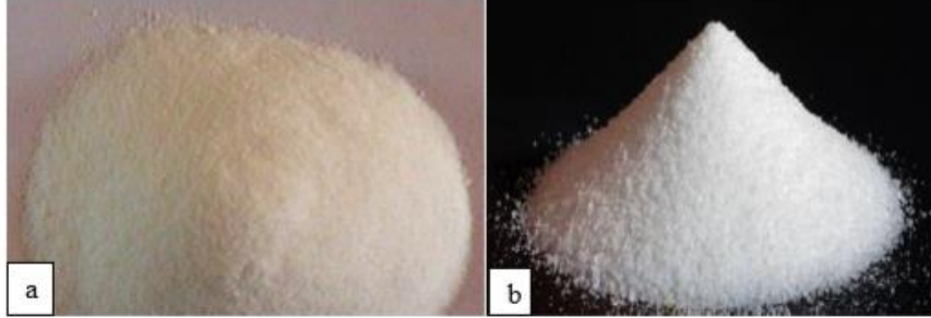
Şekil 1.8. Sertleştirici kimyasalların görünüşleri; a. Amonyum Klorür ( \text{NH}_4\text{Cl} ), b. Amonyum Sülfat ( (\text{NH}_4)_2\text{SO}_4 ) [23]
