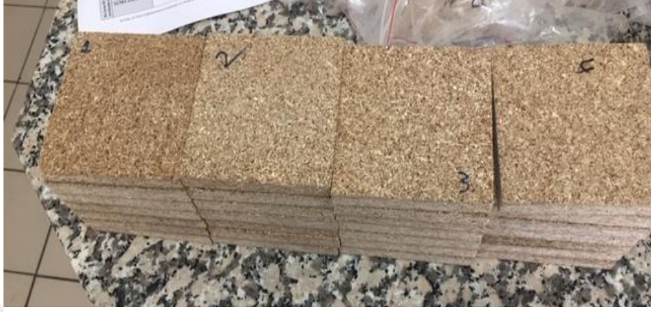
Şekil 3.14. Konik kalorimetre testine hazır olan yonga levha numuneleri
