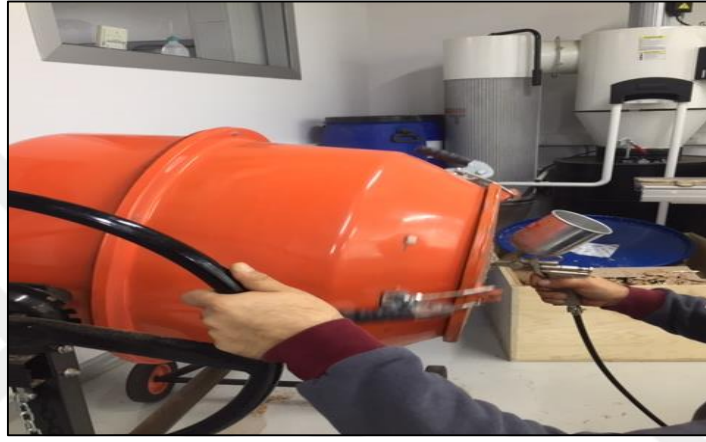
Şekil 3.2 Püskürtme işlemi ile yapılan tutkallama
