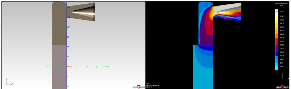
Şekil 4.11. 5. versiyon yolluk tasarımı ve simülasyon sonuçları
