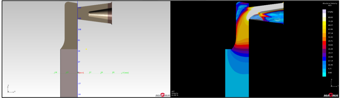
Şekil 4.10. 4. versiyon yolluk tasarımı ve simülasyon sonuçları
