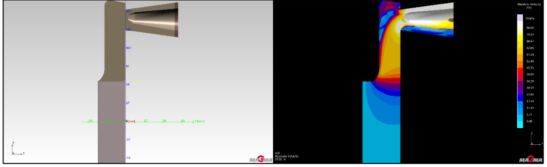
Şekil 4.9. 3. versiyon yolluk tasarımı ve simülasyon sonuçları
