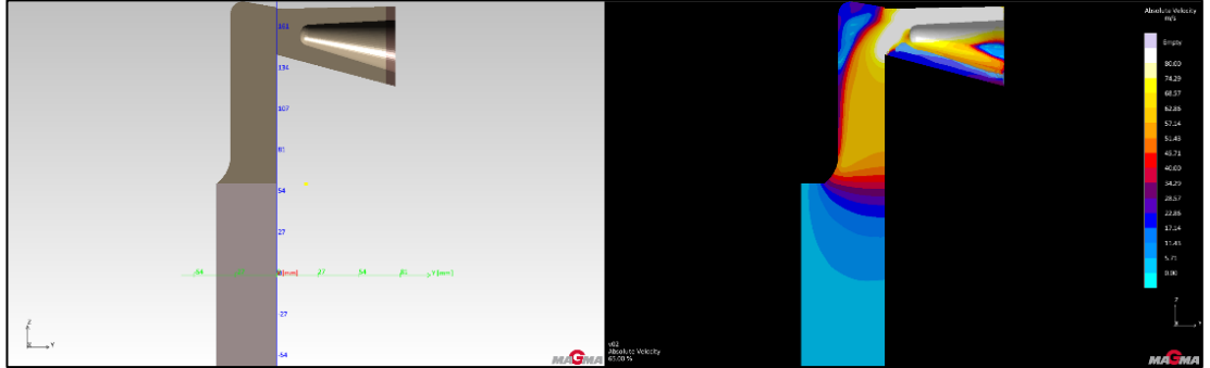
Şekil 4.8. 2. versiyon yolluk tasarımı ve simülasyon sonuçları
