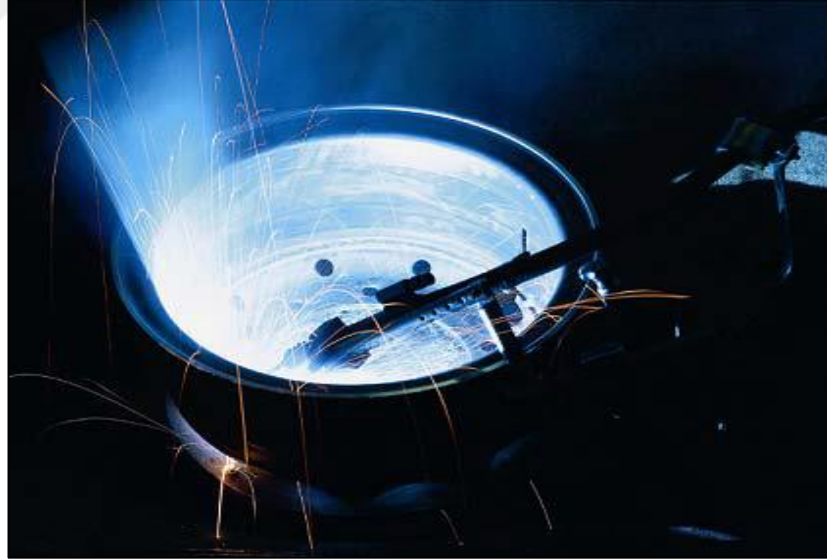
Şekil 3.6. Kaynak ile kasnak ve göbek montajının gösterimi [34]
