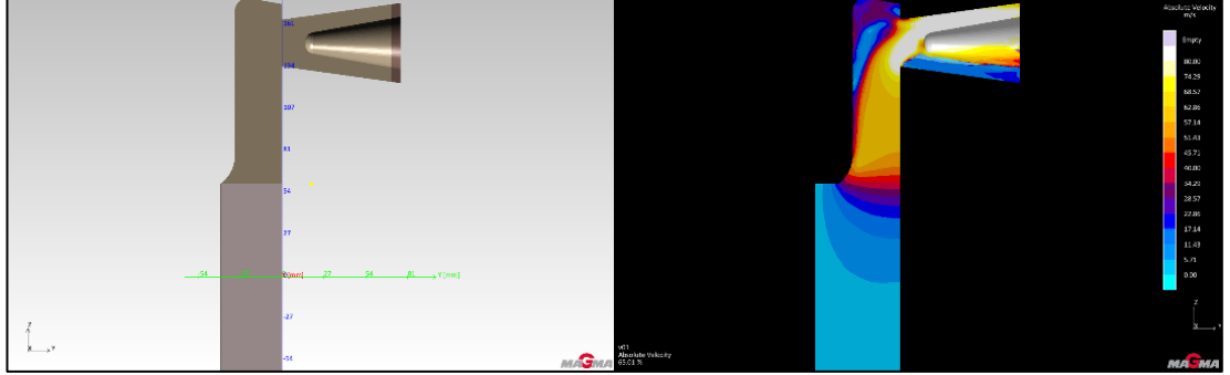
Şekil 4.7. İlk versiyon yolluk tasarımı ve simülasyon sonuçları
