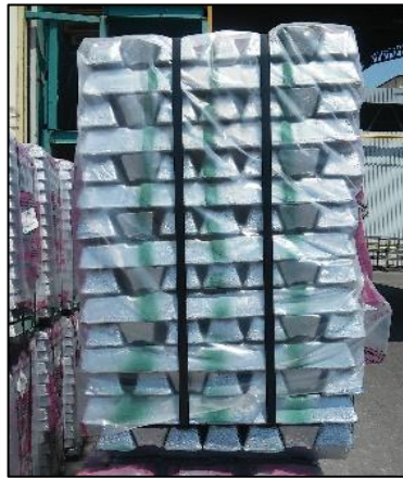
Şekil 3.8. Jant üretiminde kullanılan Al-Si alaşımli külçeler [42]
