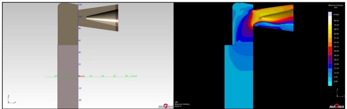
Şekil 4.15. 7. versiyon yolluk tasarımı ve simülasyon sonuçları
