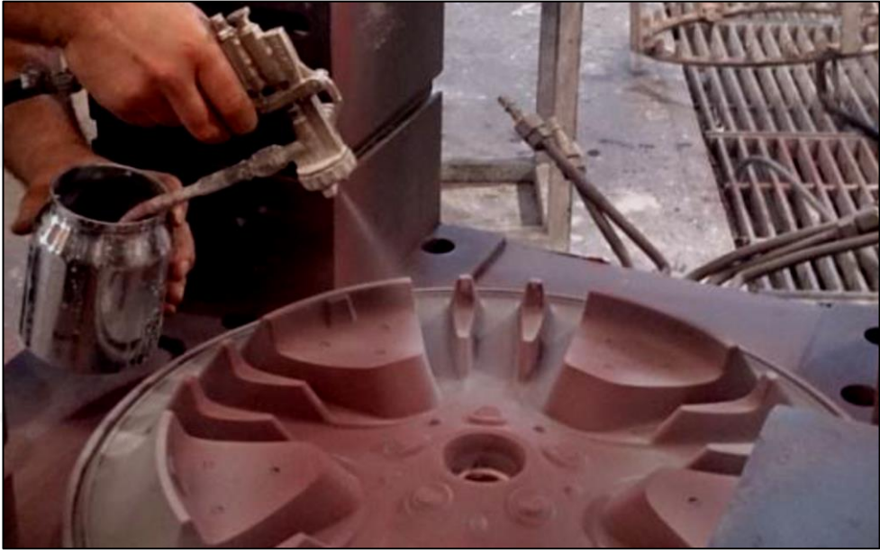
Şekil 3.14. Alt kalıp poteyaj kaplama işleminin görseli [4]
