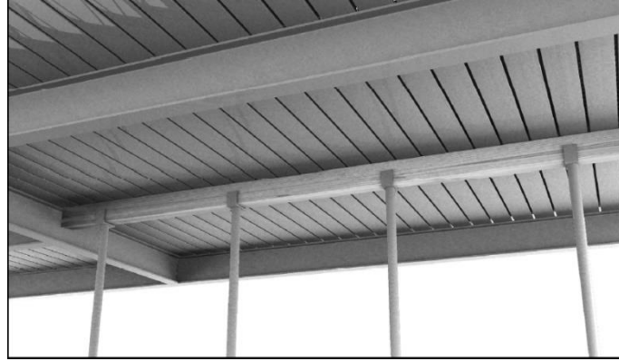
Şekil 1.5. Geçici ara destekler [9]
