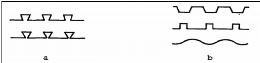
Şekil 1.2. Kompozit döşeme sistemlerde kullanılan tipik sac profilleri [1]
