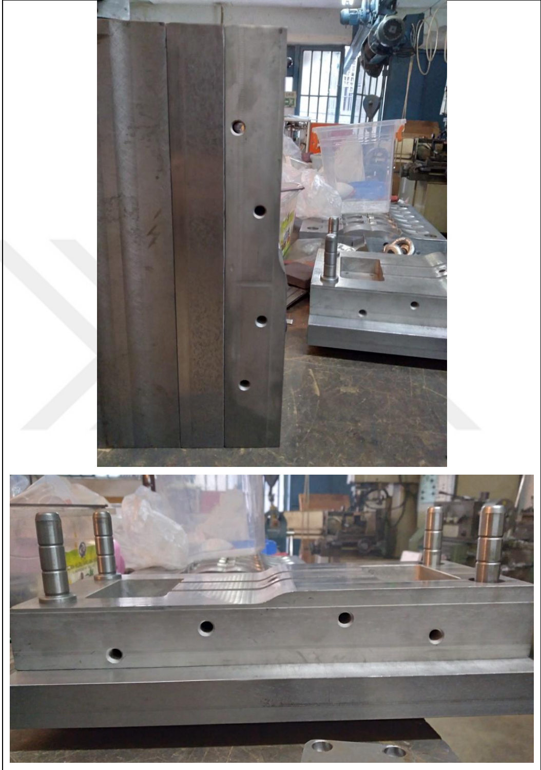
Şekil D.1. Tek kullanımlık Dilatatör üretimi için kullanılacak plastik enjeksiyon kalıbı örnek görselleri.
