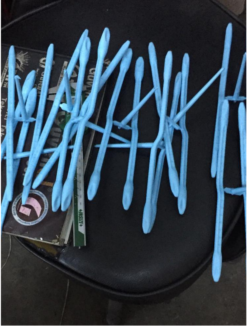
Şekil D.4. Plastik enjeksiyon kalıbı üretildikten sonra ABS malzeme ile yapılan kalıp deneme baskısı örnek görseli.
