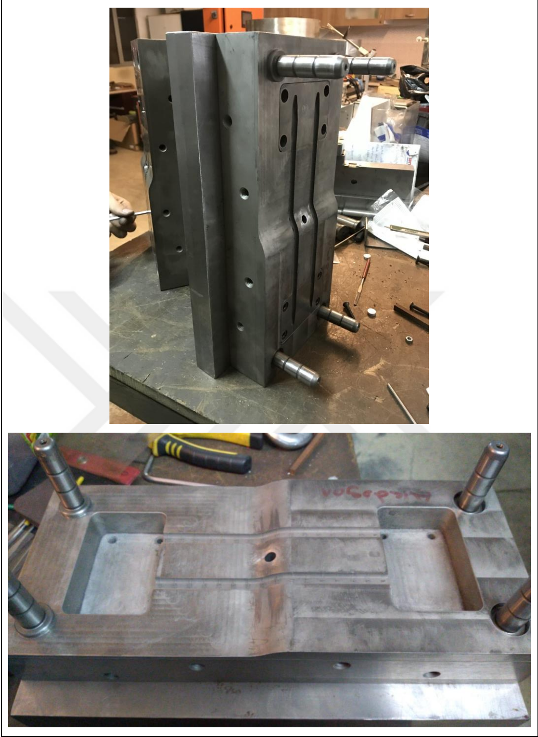
Şekil D.2. Tek kullanımlık Dilatatör üretimi için kullanılacak plastik enjeksiyon kalıbı lokma bölümü örnek görselleri.
