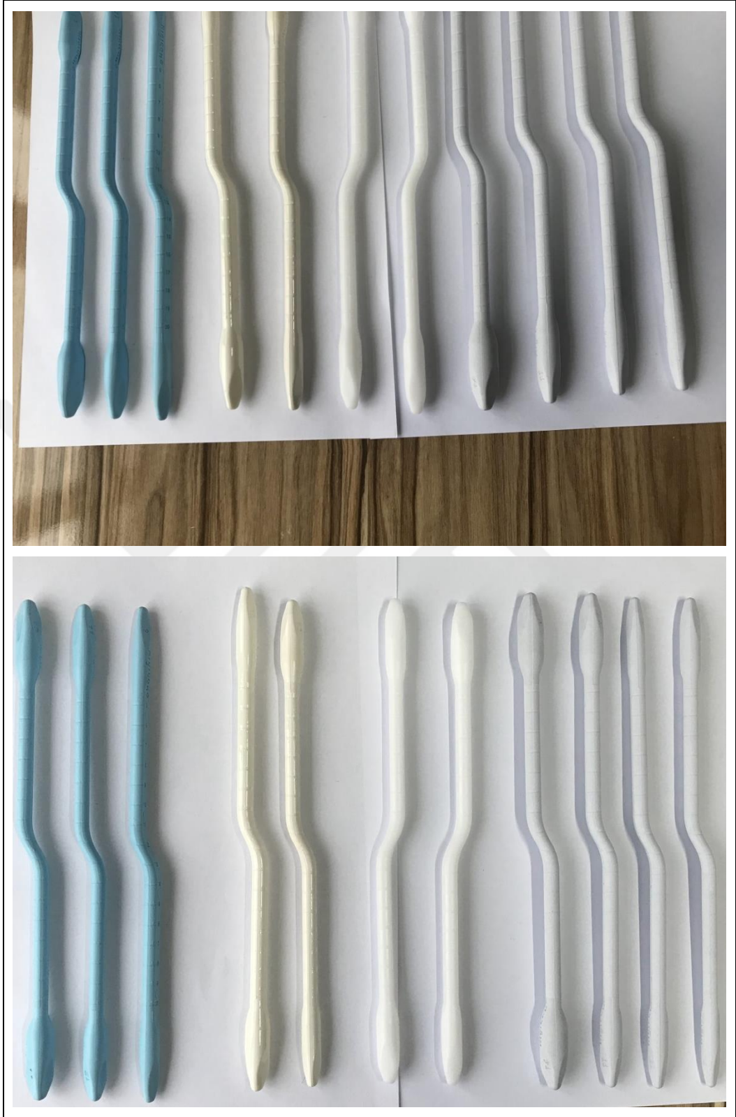
Şekil D.6. Temiz oda standartlarında, sertifikalı polimer malzemeler kullanılarak prototip üretimi yapılan tek kullanımlık Dilatatör modeli örnek görselleri.
