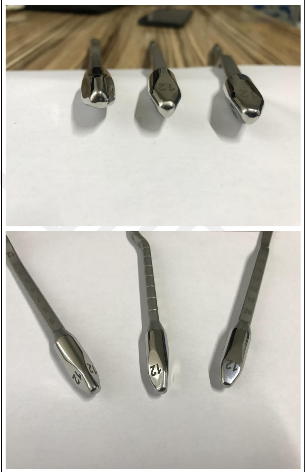
Şekil B.6. Prototip üretimi tamamlanmış çok kullanımlık Dilatatör modeli başlık kısmı farklı açılardan görselleri.
