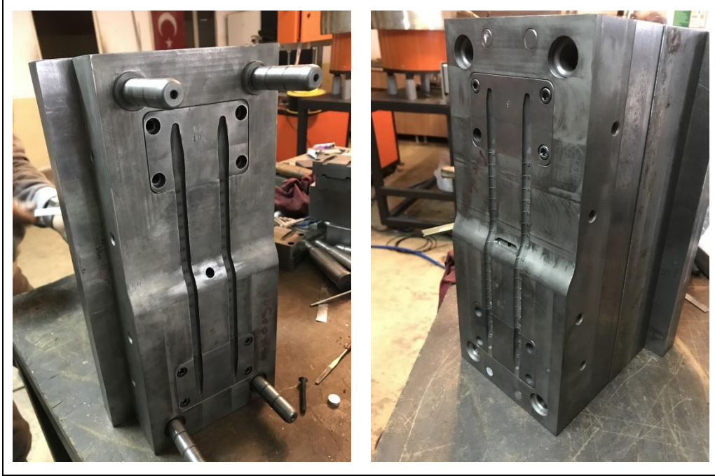
Şekil 2.6. Tek kullanımlık polimer malzemeden Dilatatör için yapılan plastik enjeksiyon kalıbı görselleri.
