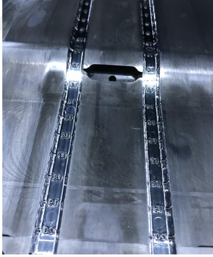
Şekil D.3. Tek kullanımlık Dilatatör üretimi için kullanılacak plastik enjeksiyon kalıbındaki ürün gözleri örnek görselleri.
