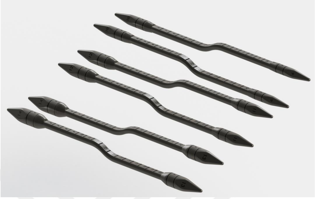
Şekil A.4. Çok kullanımlık Dilatatör modelinde yapılan üçüncü tasarım çalışmasında tutuş yönü farkı üzerine yapılan tasarım çalışması görseli.
