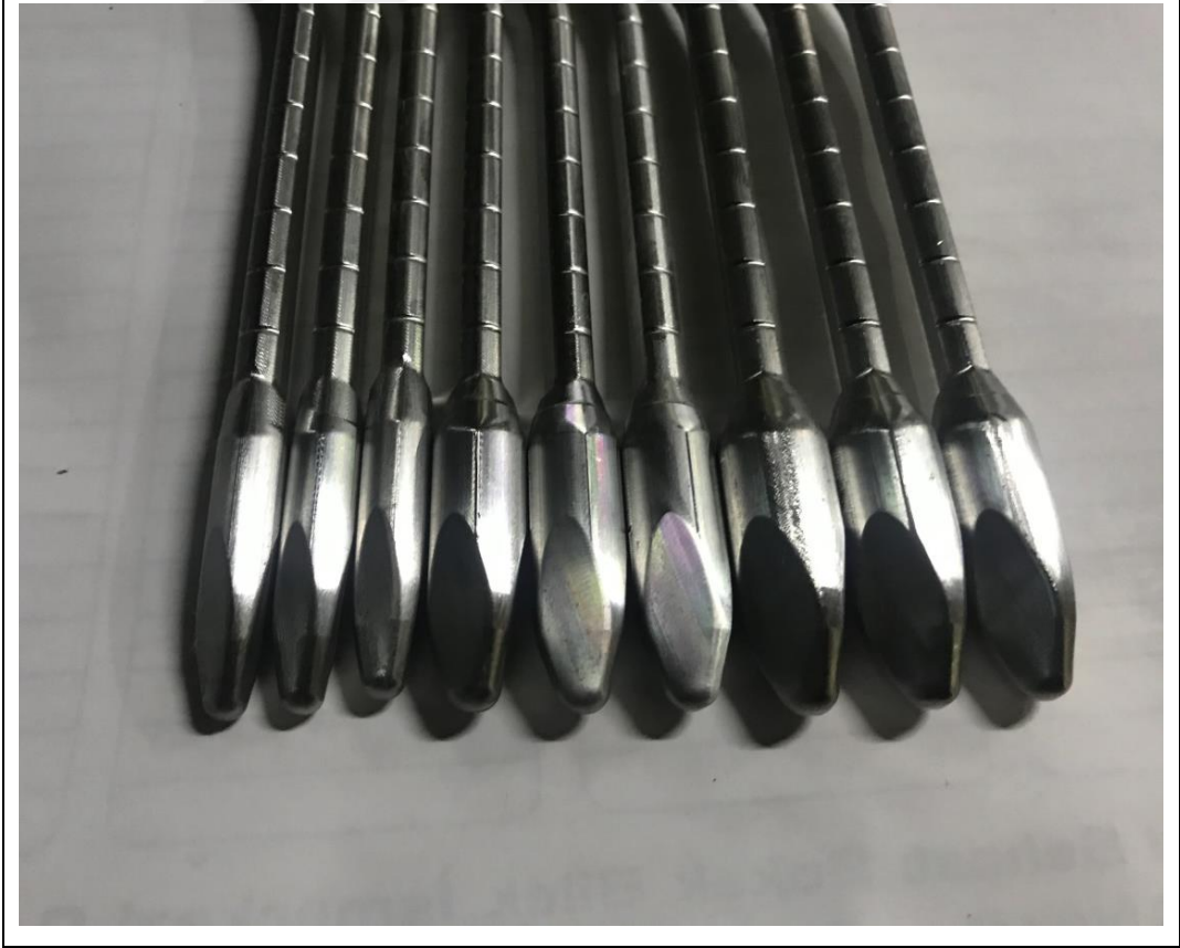
Şekil B.3. Paslanmaz Dilatatör modeli üretiminde ilk adım olan CNC dik işleme merkezinde işlenmiş ürünlerin örnek görselleri.
