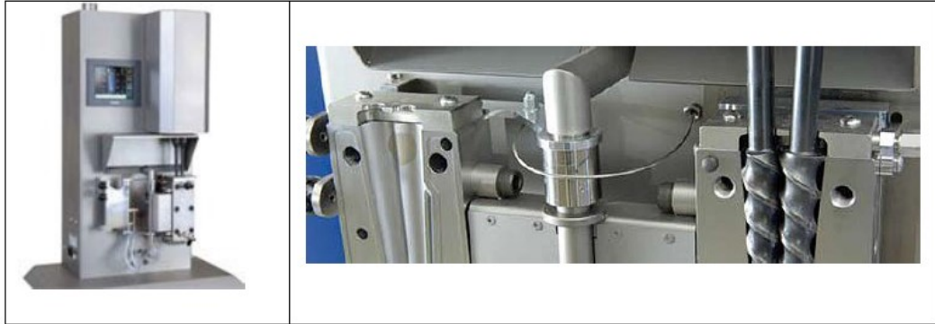
Şekil 3.1. Nanokompozit Üretiminde Kullanılan Ekstrüder
