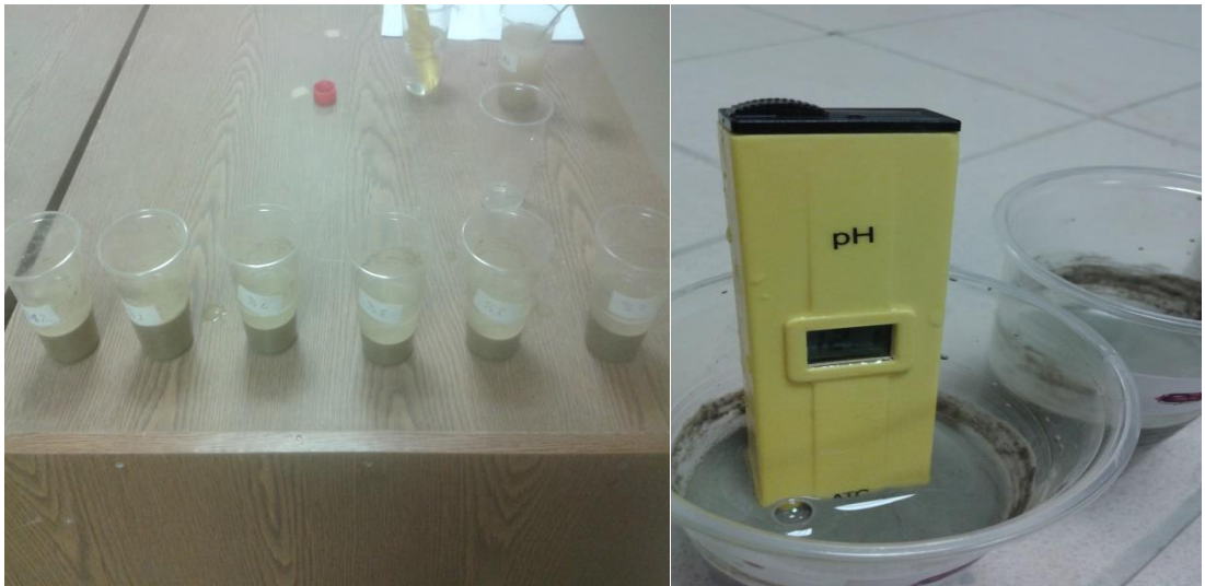
Şekil 4.4. Ph deneyi numuneleri
