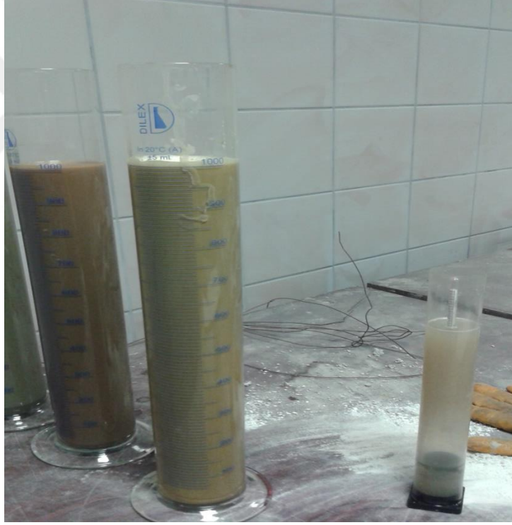
Şekil 3.5. Hidrometre deneyi aletleri
