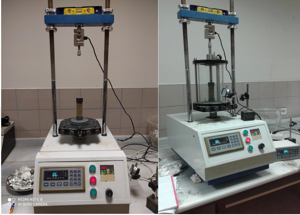
Şekil 4.8. Tek eksenli basınç deneyi
