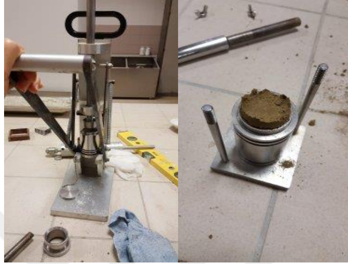
Şekil 4.7. Minyatür proktor aleti ve örnek numune
