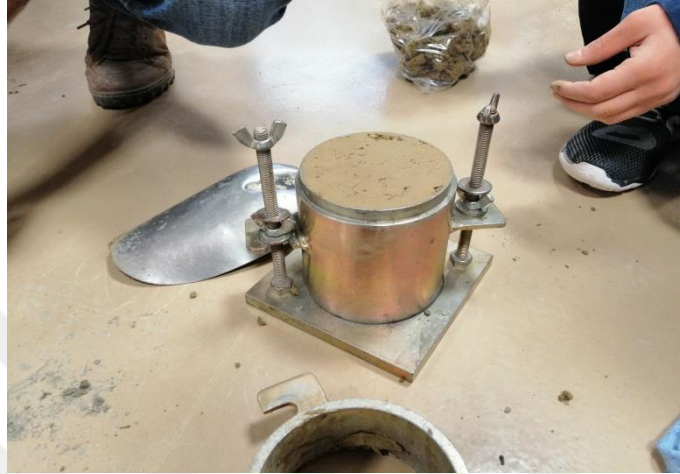
Şekil 4.5. Standart proktor deneyi
