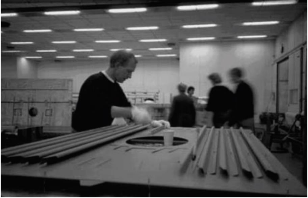
Şekil 2.2. ARALL ile üretilen F-27 Paneli (Gülcan ve diğ., 2019)
