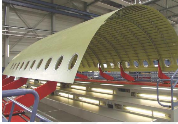
Şekil 2.5. GLARE kompozitinden üretilen üst gövde panelleri (Marsh, 2004)
