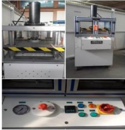
Şekil 4.6. (a) FMTK dizilimi (b) sıcak pres makinası
