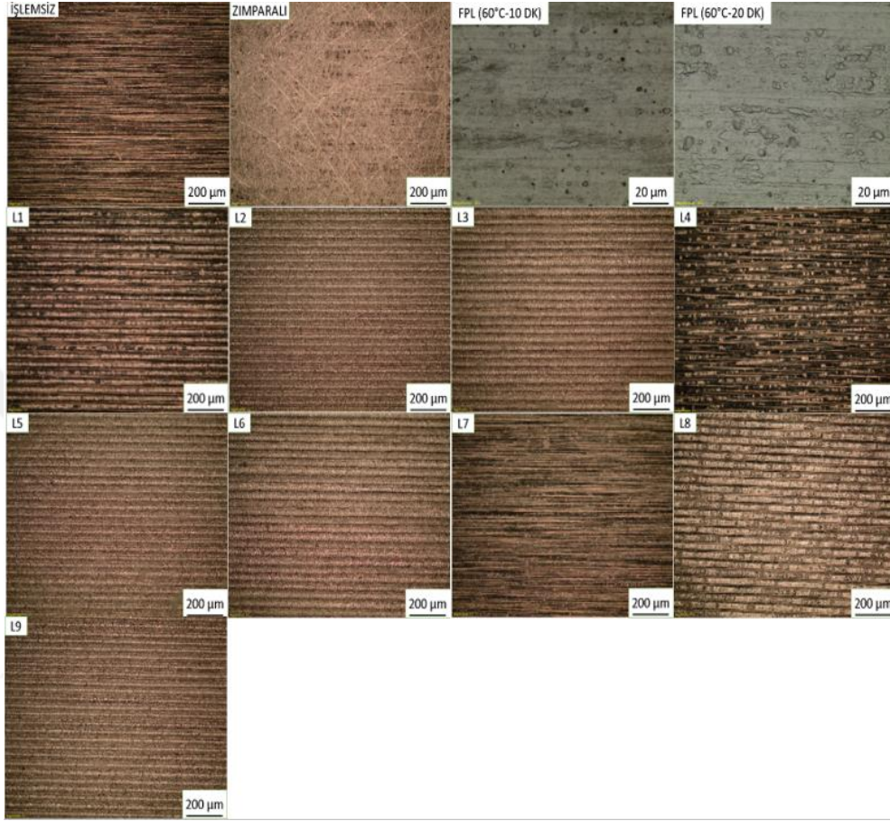
Şekil 5.2. Farklı işlemlere tabi tutulmuş numunelerin yüzey görünümleri
