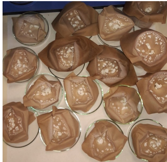
Şekil 6.5. Etüv sonrası kurutulmuş \text{Bi}_2\text{WO}_6 numuneleri
