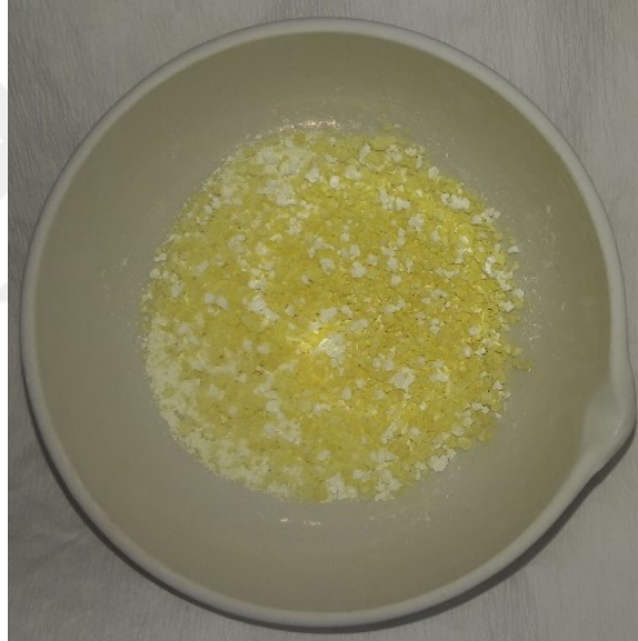
Şekil 6.6. Kül fırını sonrası \text{Bi}_2\text{WO}_6 numunesi
