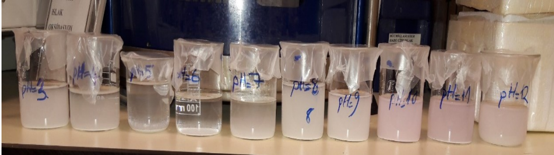
Şekil 6.7. Farklı pH değerlerinde hazırlanan \text{Bi}_2\text{WO}_6 -saf su karışımları
