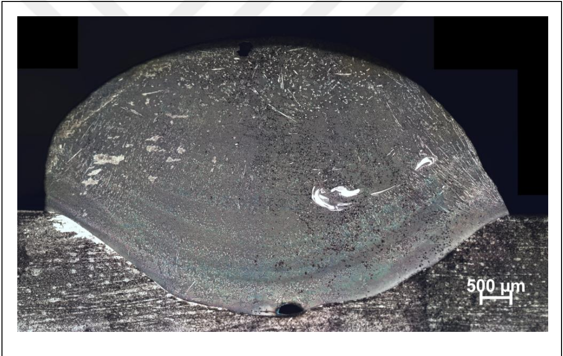
Şekil 6.2. 120 amper kaynak akımı ile yapılan sert kaynağının IM kesit görüntüsü
