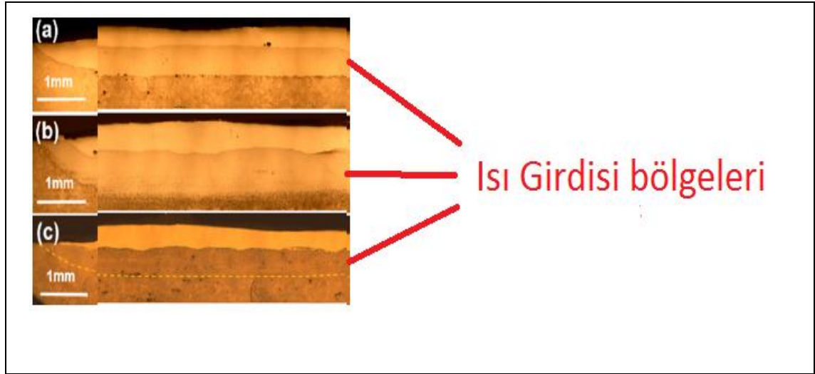
Şekil 1.6. Farklı parametreler ile lazer sert dolgu prosesi sonrası ısı girdisi [15]
