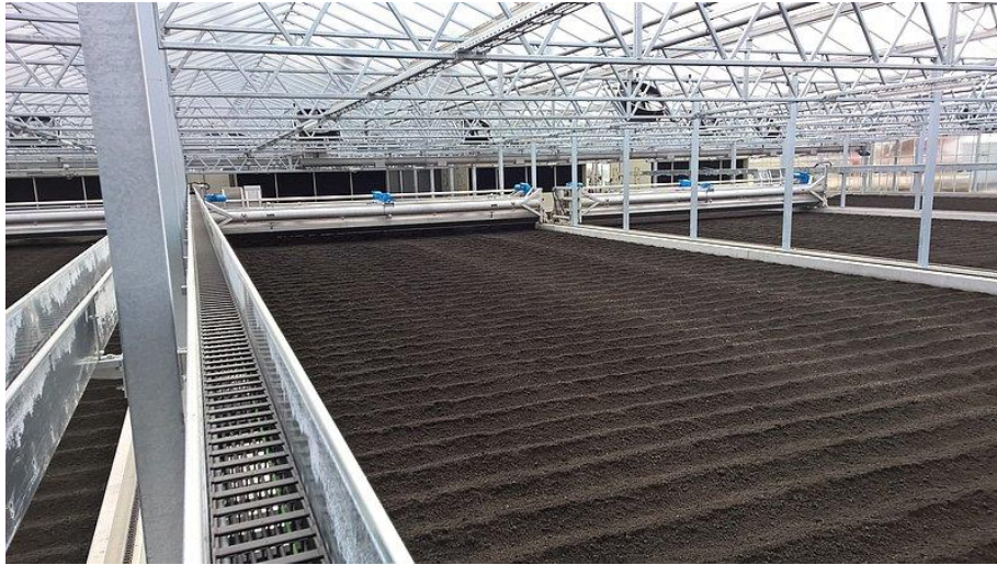
Şekil 4.9. Huber SE firması tarafından tasarlanmış otomatik karıştırıcılı (çevirici) bir solar kurutma tesisi(URL-12).
