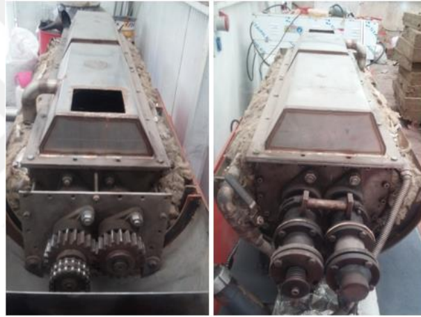
Şekil 5.9. KK Dişli tahrik ve yağ başlığı sistemi
