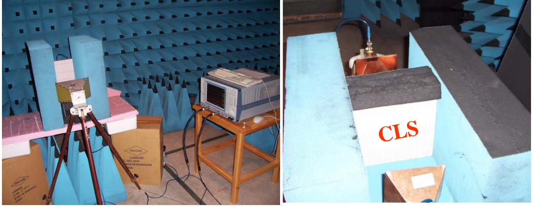
Şekil 3.15. CLS yapısının iletim/frekans ölçümleri için kullanılan düzenek.
